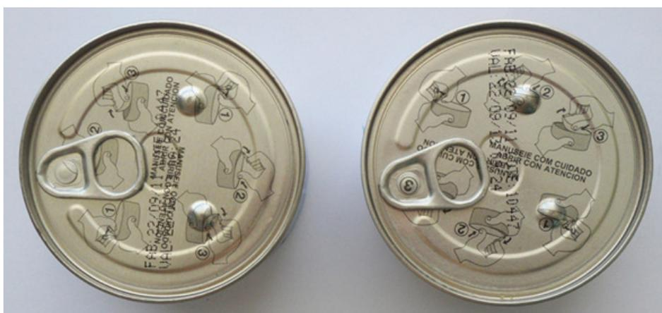
Figura 16. Exemplo de complexidade desnecessária em tampas de latas de atum da mesma marca. Devido a limitações do sistema de posicionamento do anel, as três etapas de abertura estão repetidas fazendo parecer que são seis etapas. Além disso, a impressão do lote e da validade estão sobrepostos às instruções de abertura.
